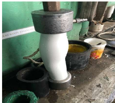
Gambar 4. Tes Pipa Melembung & Grafik Kegagalan Tes Uji Hidrostatic
