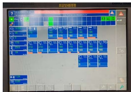
Gambar 8. Tampilan Parameter Setting Yang Mengalami Gagal Uji Hidrostatik
